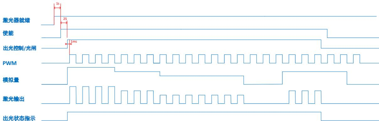
**激光器就绪：**上电自检没有问题自动输出电源使能8秒后激光器准备就绪，输出高电平24V给机床
