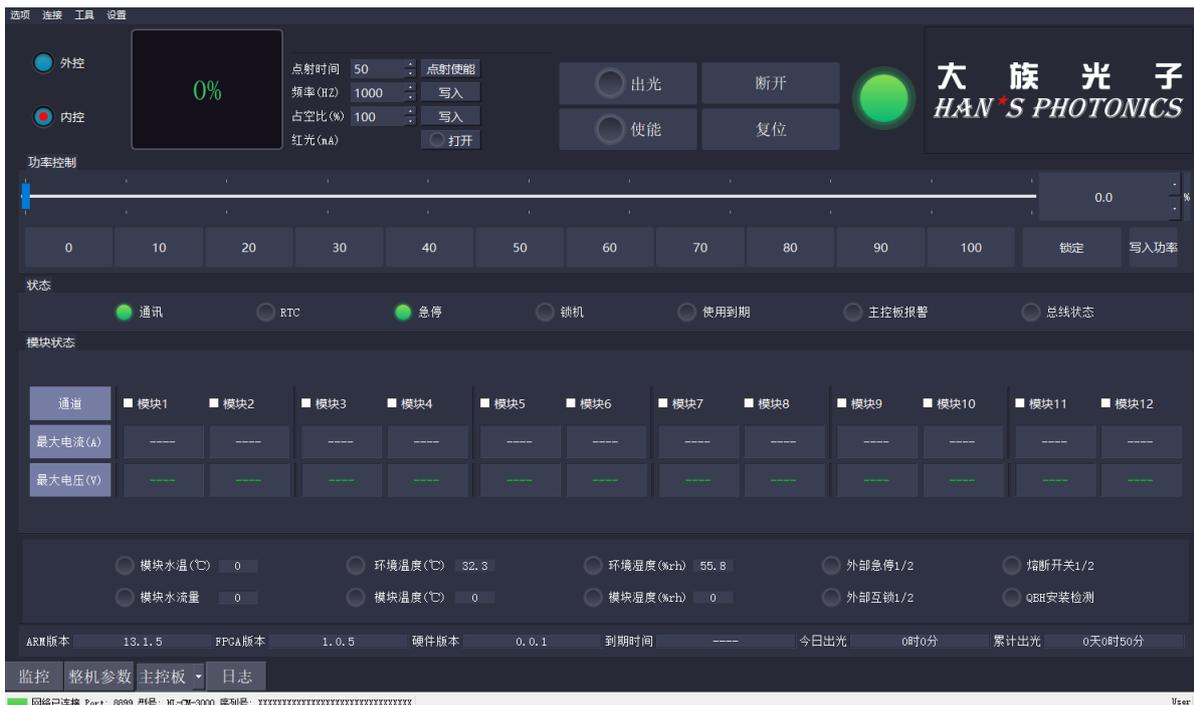
1. 内外控切换：点击内控切换至内控，点击外控切换至外控，如下图属于选中外控状态
